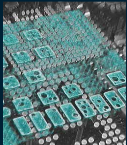
Computerlaminografie einer Leiterplatte, Schichtebene
