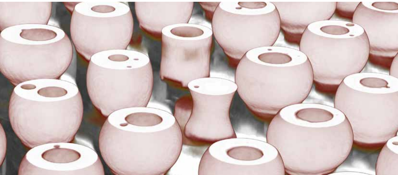
3D-CL-Bild: Lot von einem BGA-Ball ist beim Reflow in ein Via geflossen.
