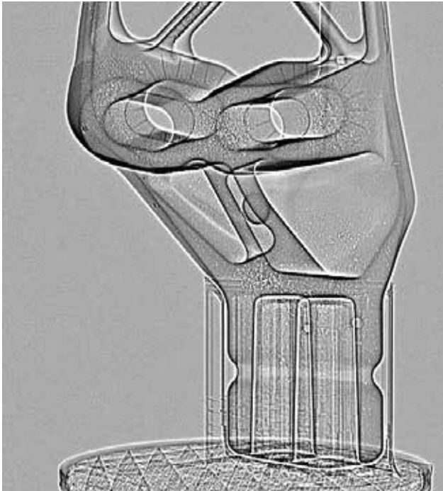
手動2D検査用に設定を最適化したX線画像
